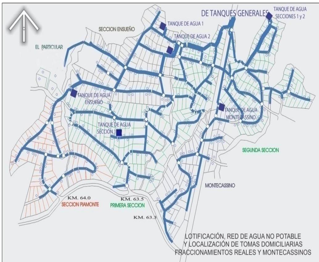
Figura 3-1 Red hidráulica del Fraccionamiento Real Montecassino, Huitzilac
