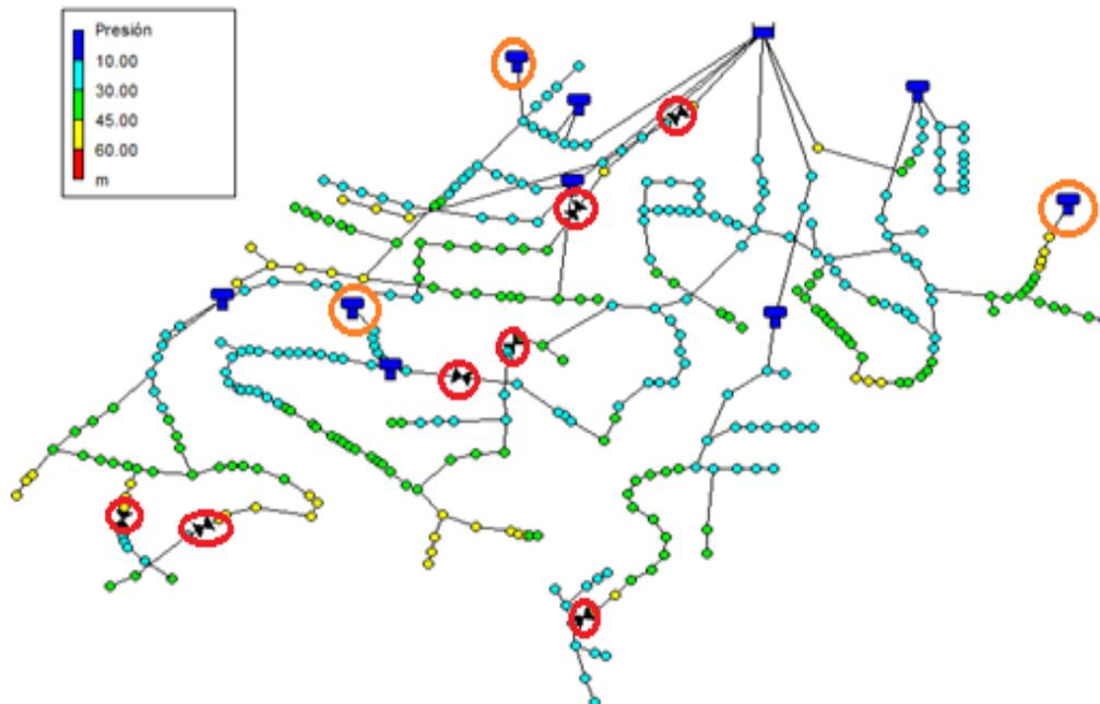
Figura 5-8 Simulación hidráulica de la mejor solución la red del FRM con 4 procesos de distribución
