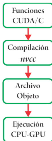
Figura 4.47 Proceso de ejecución de un programa en la GPU
