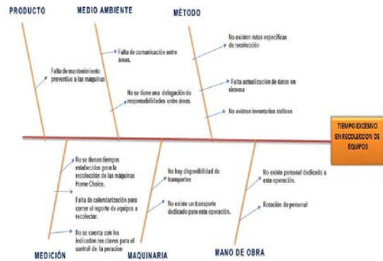
Fig. 2. Diagrama de Ishikawa realizado para el análisis de la recolección de equipos
