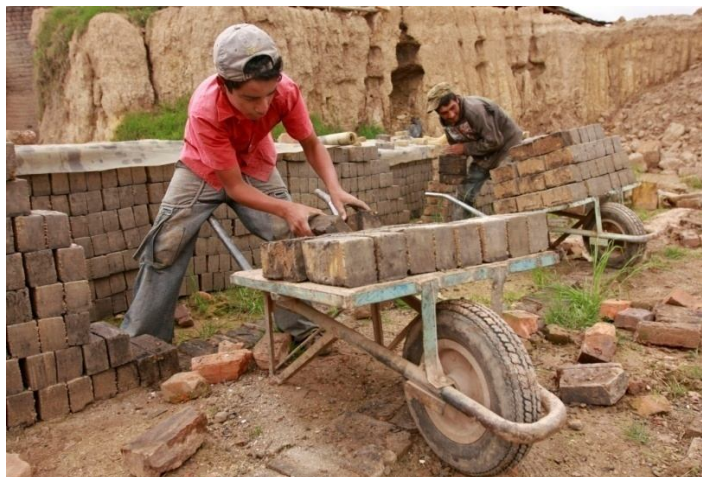
Fig. 3. Transporte de ladrillos secos hacia el horno de cocimiento.
