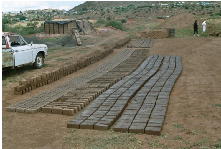
Fig. 2. Ladrillos en etapa de secado.
