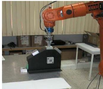
**Fig. 2.** Operación de ensamble peg-in-hole.
