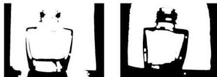
Figura 14. Imágenes Umbraladas de envases sin defectos
