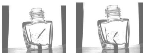
Figura 9. Imágenes de Envases con Defectos con Aumento de Brillo.
