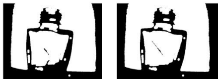
Figura 13. Imágenes Umbralada de envases con defectos
