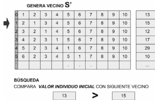
Fig. 5. Generación de un vecino
